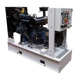
Дизель-генераторные установки открытого типа серии GF2 созданы на базе дизельного двигателя воздушного охлаждения и синхронного бесщеточного генератора с автоматической регулировкой напряжения, с блоком охлаждения со стандартным радиатором, пультом управления с котроллером.
