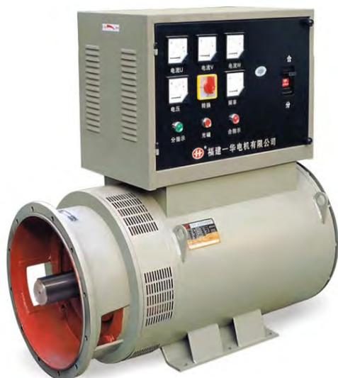
Синхронный щеточный генератор серии TZN с неуправляемым фазовым возбуждением трехфазного переменного тока - это генератор постоянного самовозбуждения с неуправляемым фазовым возбуждением путем намагничивания. Генератор имеет автоматический регулятор напряжения AVR, который имеет обратную связь и электрический комплекс реактивного фазосдвигающего и токового индукционного устройства.
